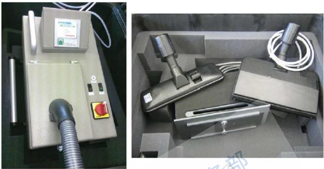
图D.1 带被动和动力喷嘴及真空校准试验箱的RSB
